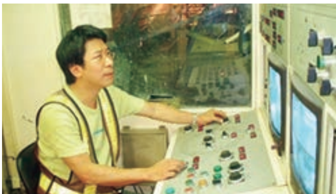
作者在 TBM 主控室開挖操作情形
