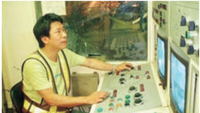
作者在 TBM 主控室開挖操作情形
